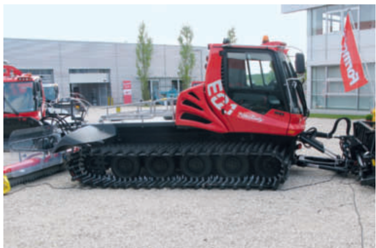
PistenBully EQ.1 с дизель-электрическим приводом
