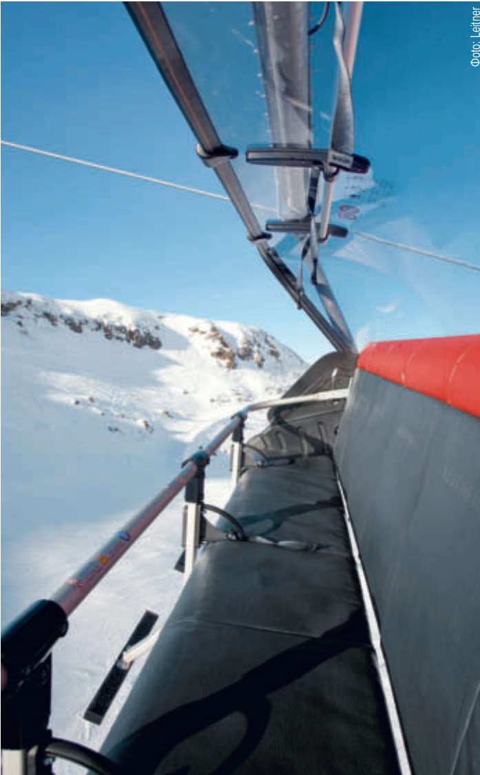
Комфорт для лыжников и оснащение класса люкс: 8-местный подъемник с обогревом сидений и защитным колпаком
