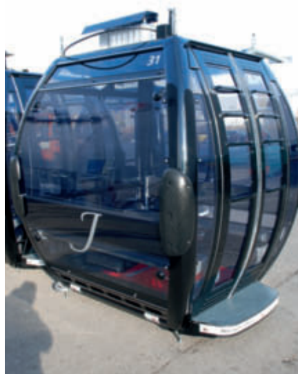
OMEGA IV – VIP, также известная как «Jewel Box», с системой электропитания типа «SuperCar»
