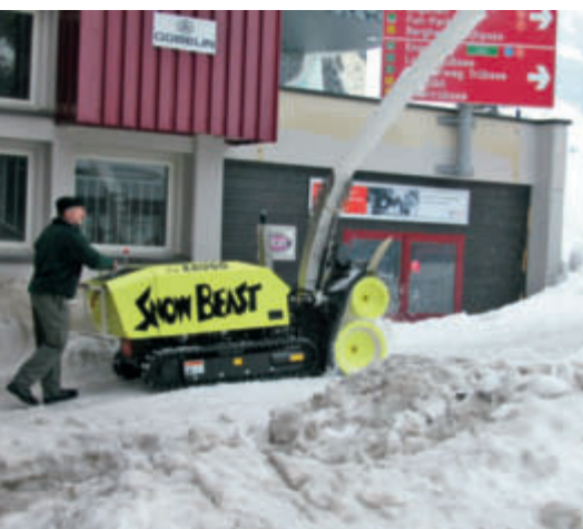
"Snow Beast" компании Zaugg с двухступенчатым снегоочистителем
