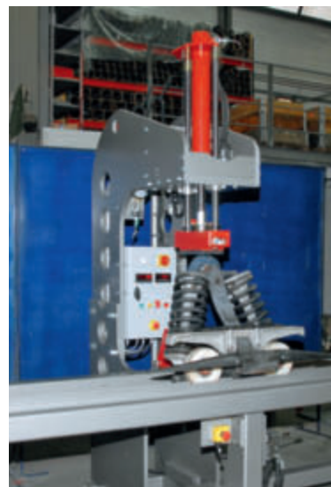
Die von Coppel Maintenance entwickelte Prüfmaschine für kuppelbare Klemmen
