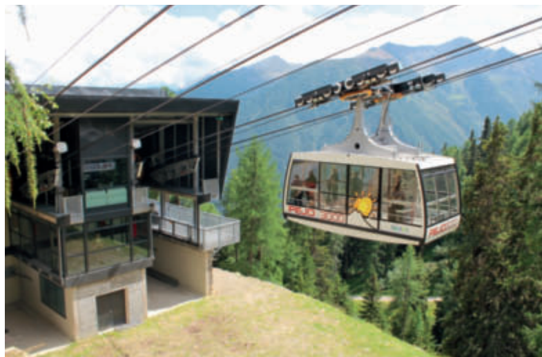
In der Talstation Tarlenta auf 2.000 m ü. M. befinden sich beide Antriebe der Funifor Pejo 3000.
